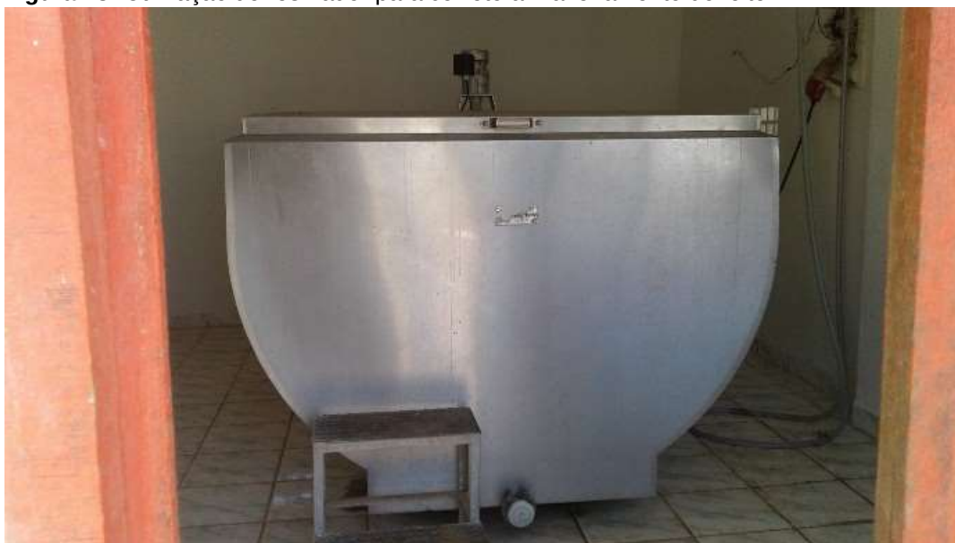
Figura 18: Utilização de resfriador para correto armazenamento do leite.
