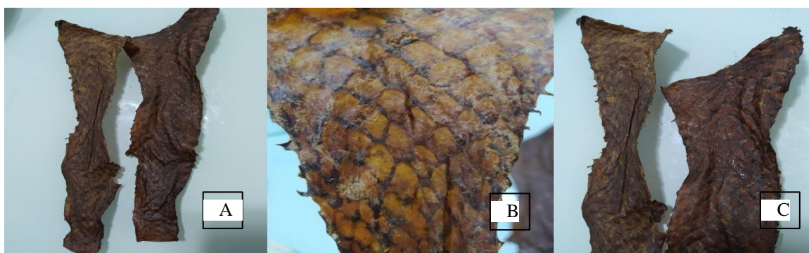
Figura 9: Processo de curtimento utilizando a casca do café ( Coffea sp.): a) espessura da pele b) parte interna da pele c) parte externa da pele
