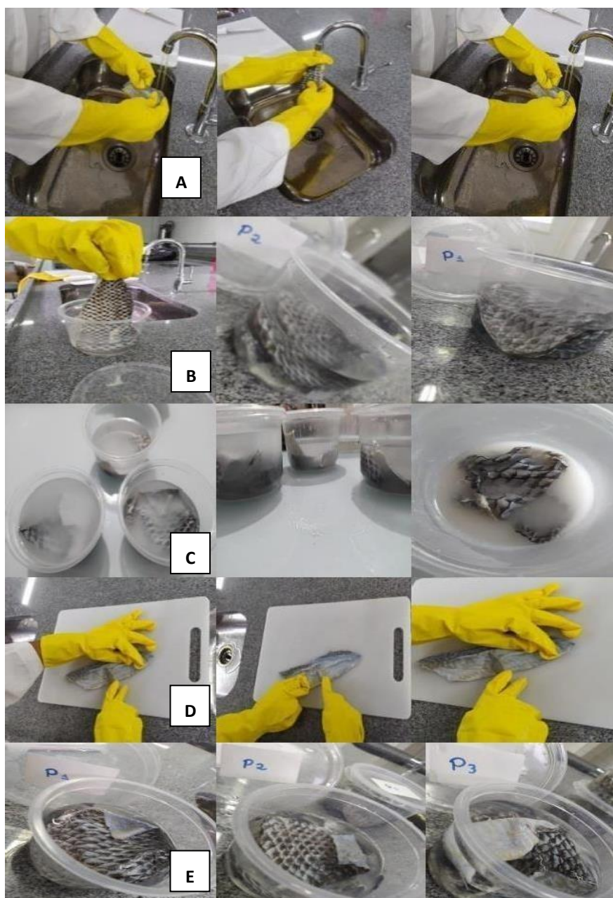
Figura 3: Preparação da pele: A: etapa de lavagem B: etapa de remolho C: etapa de caleiro D: etapa de descarne E: etapa de desencalagem.
