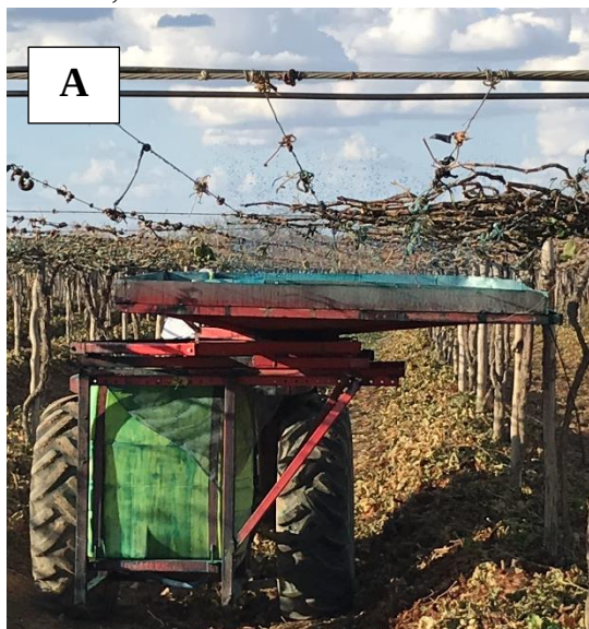
Figura 19 – (A) Aplicação tratorizada de cianamida hidrogenada utilizando o “bandejão”; (B) Detalhe: barra aplicadora de baixa pressão e bandeja coletora de calda que equipam o “bandejão”, Fazenda TopFuit, Petrolina, 2018.
