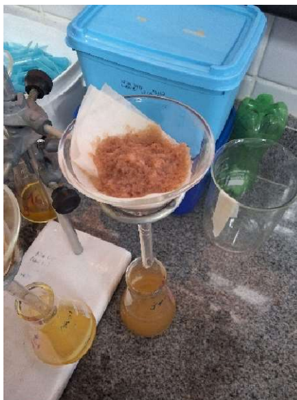
Figura 13. Etapa de filtração do melmel de jambo-vermelho a 30% p/v.
