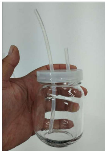
Figura 9. Recipiente de vidro com tampa, capacidade 250 mL, utilizado para a fermentação alcoólica.
