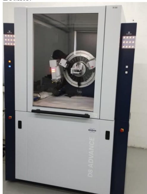
Figura 3 – Equipamento de difração de Raios X (DRX) modelo D8 ADVANCE da Bruker.
