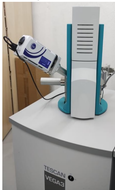
Figura 2 – Microscópio Eletrônico de Varredura (MEV) com Espectroscopia por Dispersão de Elétrons (EDS) modelo TESCAN 3.
