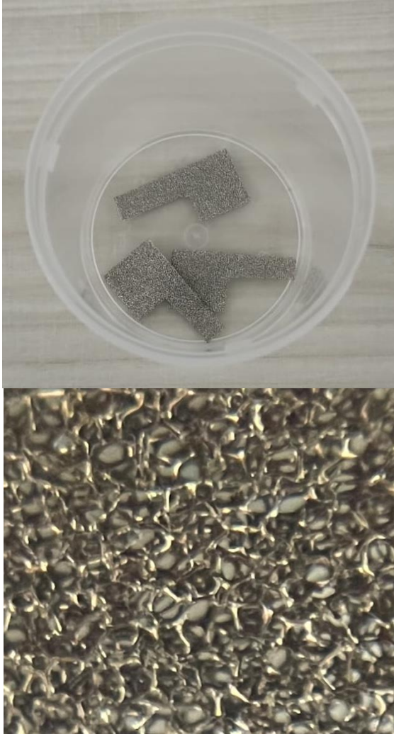
Figura 9 – Catalisadores depositados na espuma de níquel constituindo o eletrodo.
