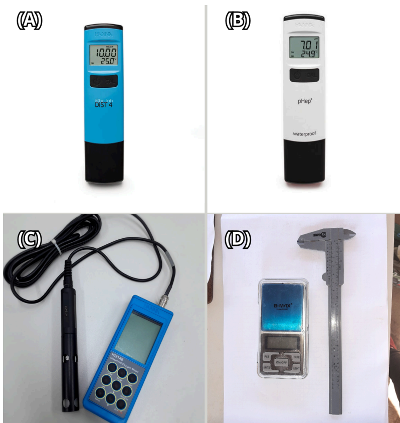
Figura 4 – Instrumentos utilizados para aferir os parâmetros físico-químicos da água: (A) Tester de condutividade; (B) pHmetro; (C) Oxímetro; (D) Balança digital e paquímetro.
