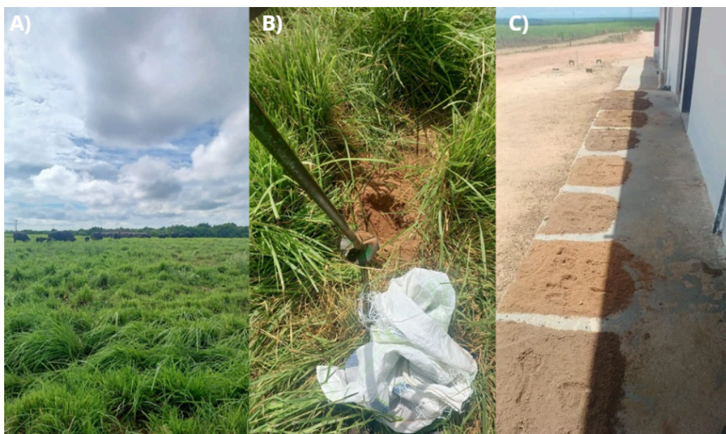
Figura 15. A) Piquete para coleta de amostra de solo; B) Retirada da amostra; C) Amostras separadas para secagem ao sol.
