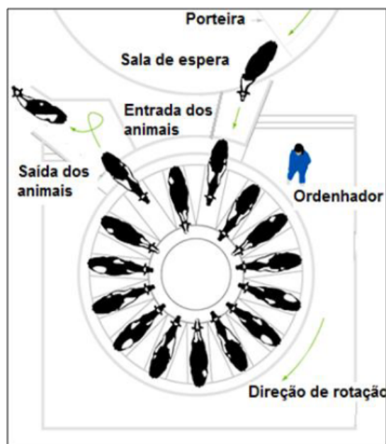
Figura 2. Modelo esquemático da ordenha em carrossel Fonte: Comercial Gerdau, 2015.
