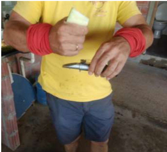
Figura 22: Uso de refratômetro para avaliação do teor de açúcar do fruto.
