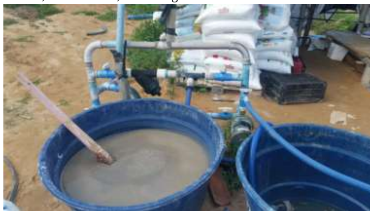
Figura 10: Caixas para preparo da calda da fertirrigação e sistema Venturi, com válvulas, filtro e registros.
