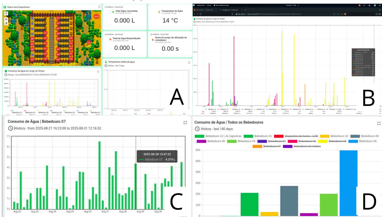
Figura 8 - Dashboard do bezerreiro com todas unidades de bebedouro (A); Gráfico disponível no dashboard do bezerreiro sobre consumo de água ao longo do tempo (B); página do bebedouro 07 (C) e consumo de água dos último 140 dias de todos os bebedouros (D).
