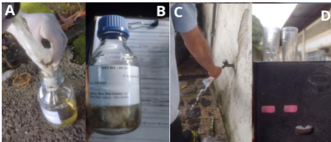
Figura 4 - A: Coleta de MECHA; B: MECHA em frasco de Duran Schott; C: coleta de água; D: avaliação do cloro residual, onde coloração rosa indica a presença de cloro residual livre.
