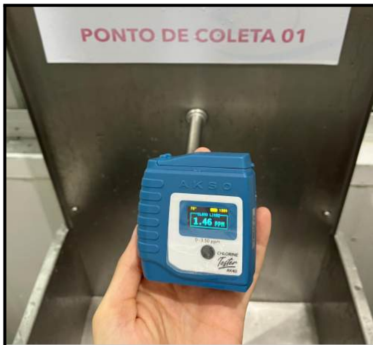
Figura 15. Clorímetro indicando alto valor de cloro residual livre.
