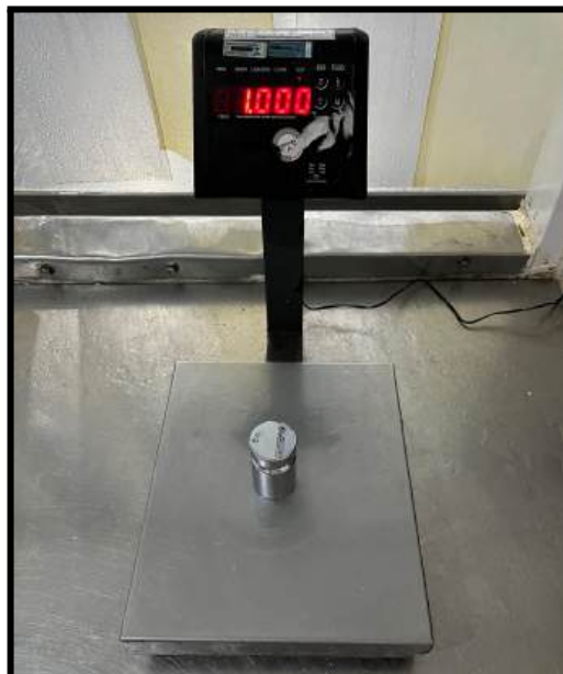
Figura 17. Verificação de calibração da balança com peso padrão.
