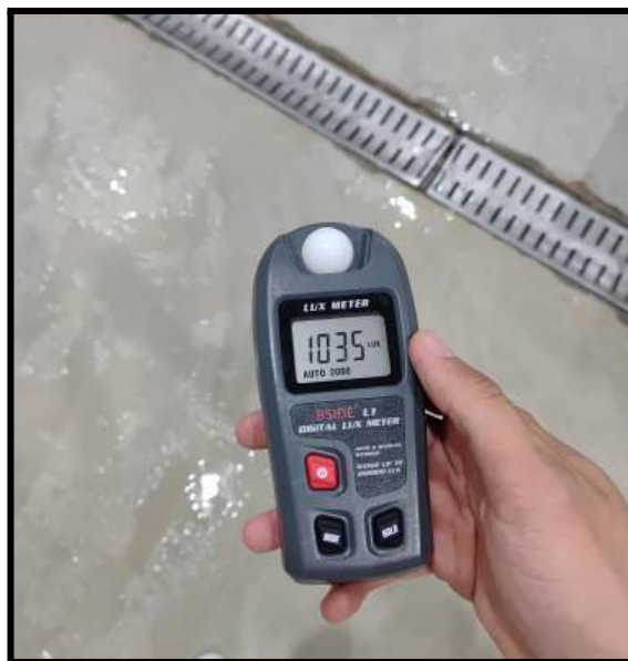
Figura 18. Mensuração de lux na sala de produção com Luxímetro.
