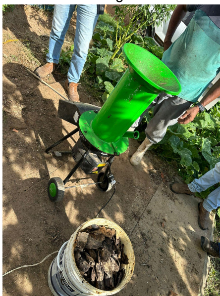
Figura 33. Máquina tipo forrageira usada para triturar os caroços secos das mangas. Fonte: Autora (2024).
