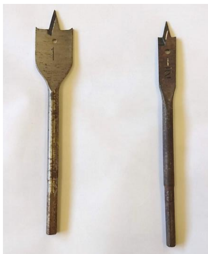
Figura 7 – Brocas chatas utilizadas para realizar as perfurações, à esquerda, broca de 1" e, à direita, broca de \frac{1}{2} ".
