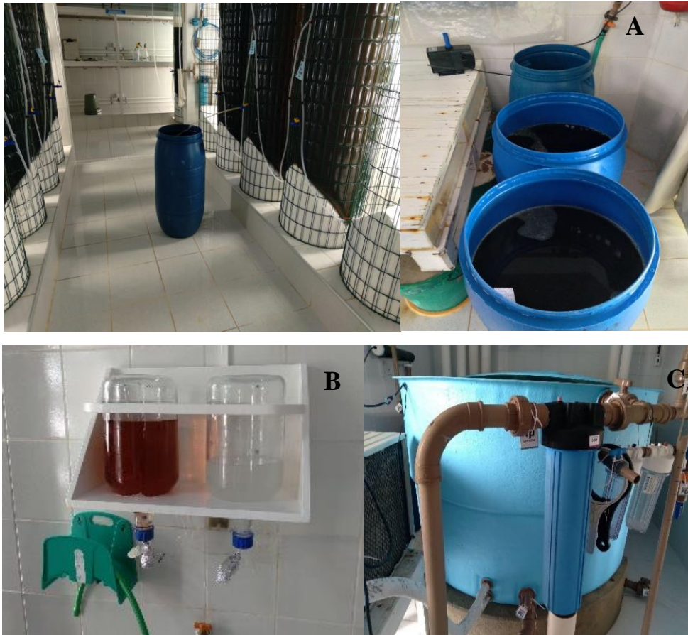
Figura 5: A retirando microalgas das torres, B nutriente e sílica, C caixa que armazena água para o manejo das torres.
