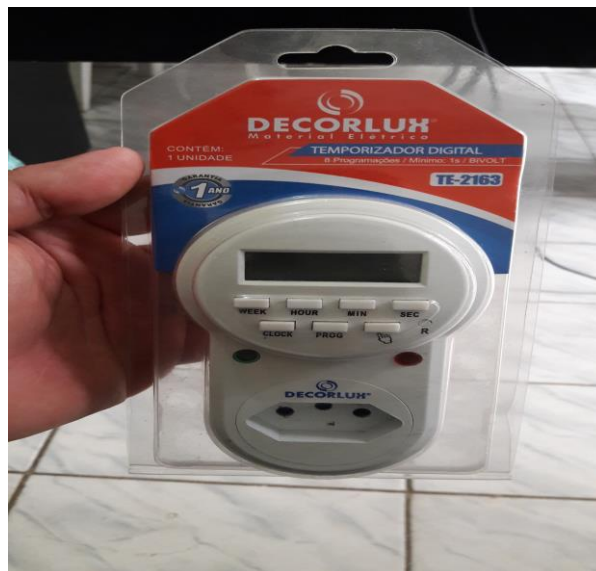
Figura 4: Timer - temporizador digital para controle de funcionamento elétrico.
