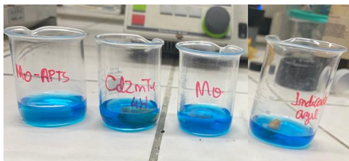
Figura 19 – Soluções com o indicador azul de metileno contendo \text{MoO}_3\text{-APTS} , \text{MoO}_3\text{/CdZnTe} (4 horas de aquecimento), \text{MoO}_3 , padrão azul de metileno.
