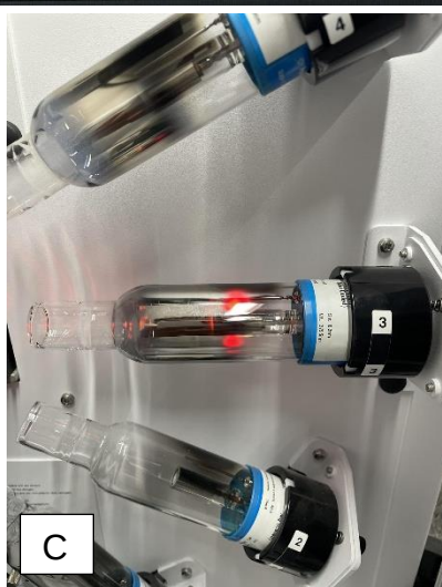
Figura 4: A tela absorção atômica; B Aparelho absorção atômica; C Lâmpadas de análise; D Cachimbo de solo
