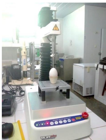
Figura 30. Análise da resistência da casca
