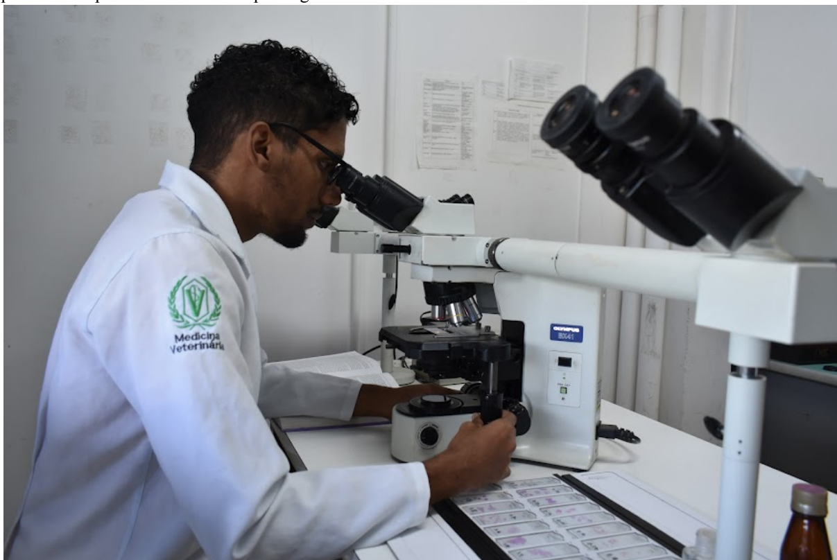
Figura 3. Sala dos residentes, representação do microscópio óptico do tipo medusa, o que permite mais de uma pessoa acompanhar a lâmina histopatológica simultaneamente.
