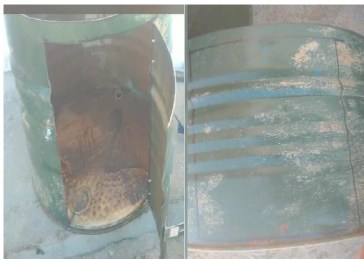
Figura 3 - Corte para porta da base do defumador
