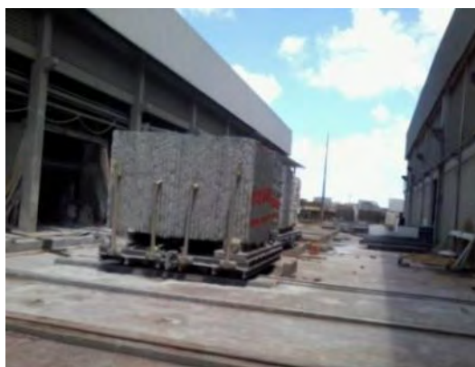
Figura 2: Blocos serrados em chapas.
