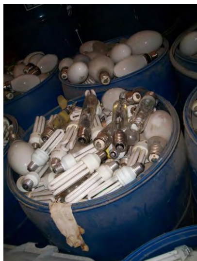
Figura 4. Acondicionamento das lâmpadas fluorescentes pós-consumo da instituição A é realizada nas bombonas de plástico (separada por modelo rosável). Fonte: os autores (2014).
