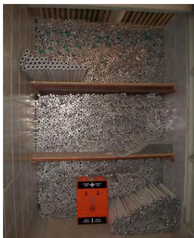
Figura 2. Área interior da Unidade de Armazenamento Temporário de Resíduos (UATR), destinando ao recebimento, seleção, acondicionamento, armazenamento dos resíduos das lâmpadas fluorescentes pós-consumo da instituição A. Fonte: os autores (2014).
