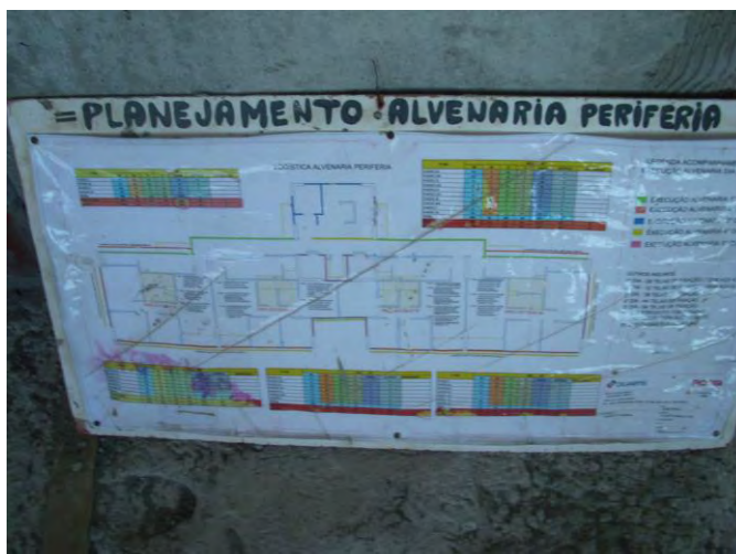
Figura 1. Planta didática de pavimento na Obra B. Fonte: os autores (2014).
