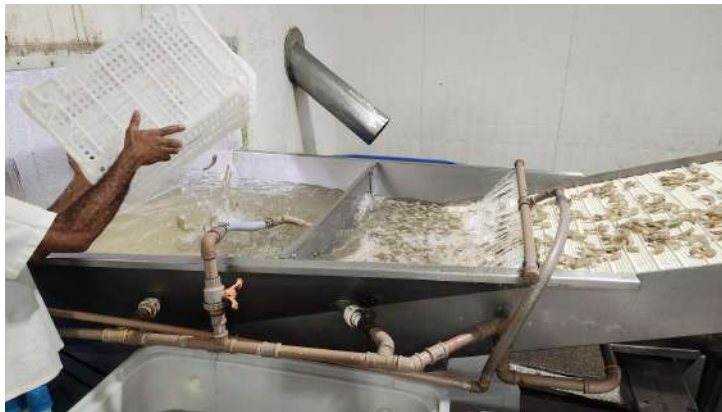
Figura 20- Camarões sendo despejados no tanque da máquina classificadora.
