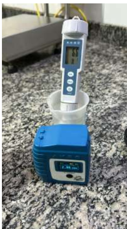
Figura 55 - pHmetro e equipamento medidor de cloro livre na água.
