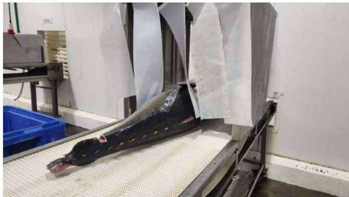
Figura 45 - Passagem do atum pela esteira recebendo a lavagem com água clorada sob pressão.
