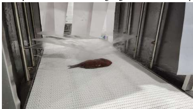
Figura 9- Segunda lavagem do peixe 2 em esteira com água gelada e clorada sob pressão de alta intensidade.
