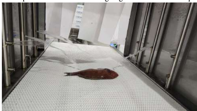
Figura 8 - Segunda lavagem do peixe 1 em esteira com água gelada e clorada sob pressão de baixa intensidade.
