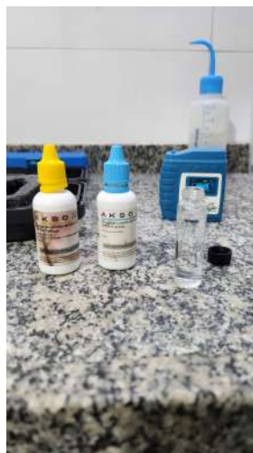
Figura 54 - Reagentes líquidos utilizados para medição do cloro livre na água.
