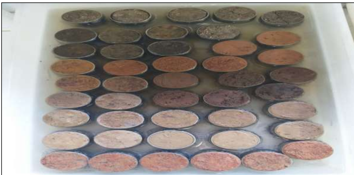
Figura 2 - Amostras de solos indeformadas em processo de saturação.
