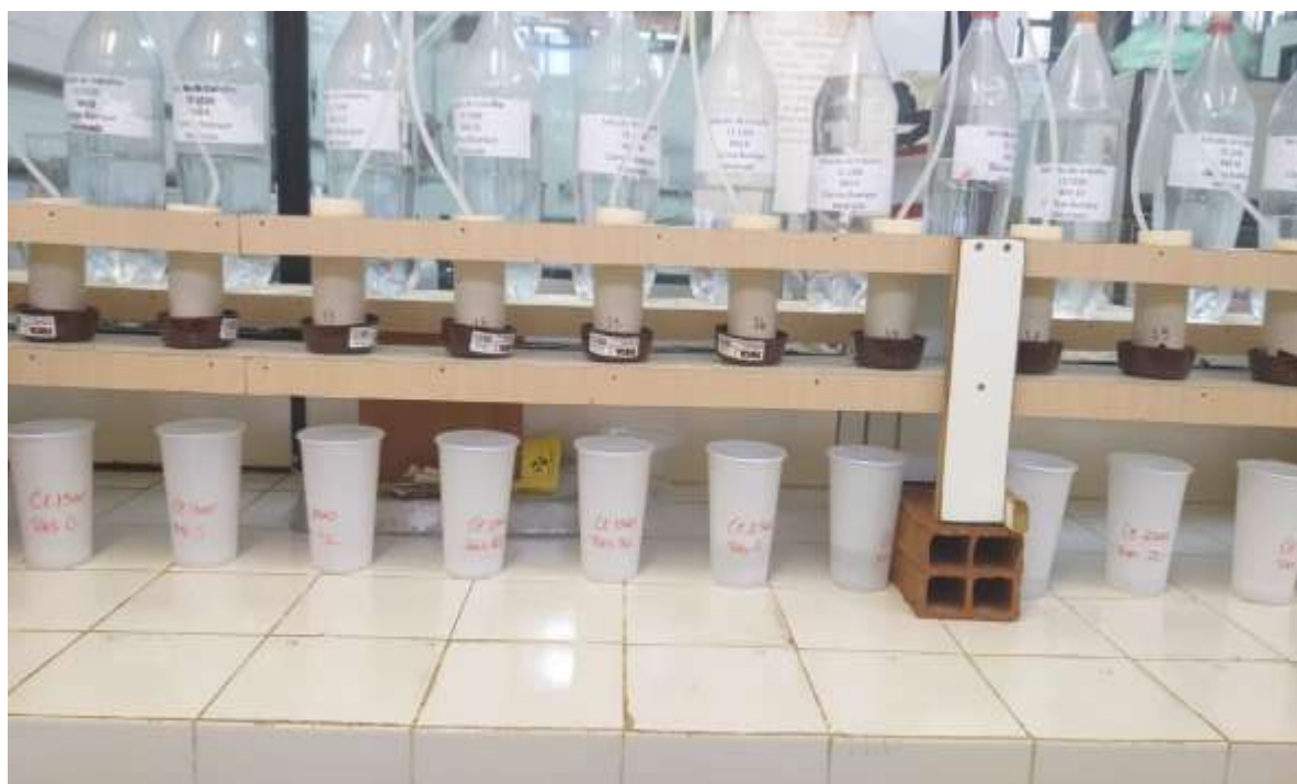
Figura 3 - Estrutura montada para o ensaio de condutividade hidráulica
