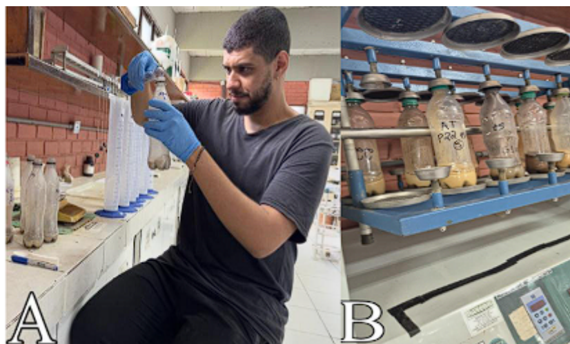
Figura 13. A) Preparação da amostra para a análise granulométrica, com adição de dispersante ao solo. B) Garrafas contendo as amostras no agitador tipo Wagner durante o processo de dispersão. Fonte: Autor.
