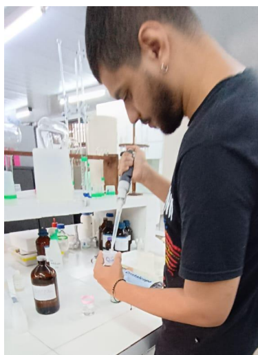
Figura 14. Participação nas etapas de análise de fósforo disponível no solo, incluindo preparo das amostras, extração pelo método Mehlich-1 e leitura espectrofotométrica. Fonte: Autor.
