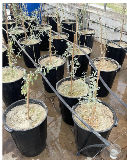
Figura 12. Sistema de irrigação por gotejamento utilizado no experimento, composto por emissores autocompensantes distribuídos ao longo da linha lateral. Fonte: Autor.
