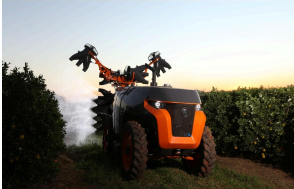
Figura 2. Pulverizador Arbus 4000 JAV da Jacto.
