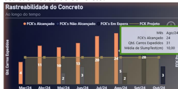
Figura 14 – Tooltips integrado a rastreabilidade de concreto.
