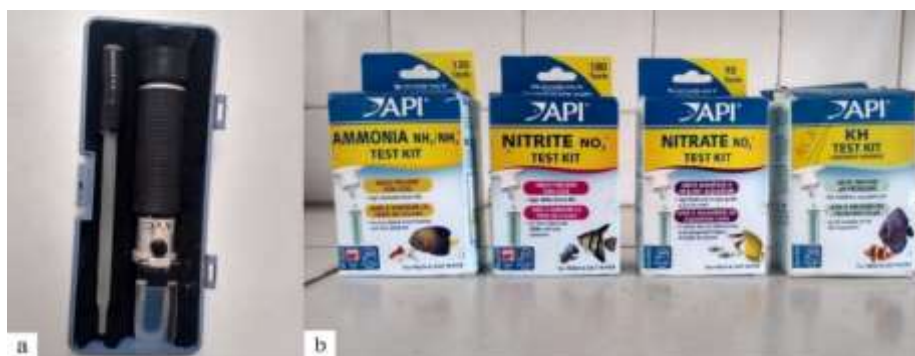
Figura 7 - (A) Refratômetro usado para verificar a salinidade. (B) kits colorimétricos usados para verificar amônia, nitrito, nitrato, fosfato e alcalinidade.
