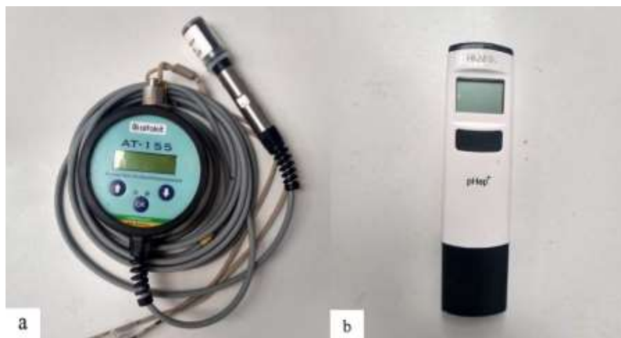
Figura 6 - (A) Oxímetro digital AT-155 da ALFAKIT utilizado para aferir oxigênio dissolvido (mg/ L) e a temperatura (°C). (B) medidor de pH pHep®+ Hanna usado para aferir o potencial hidrogeniônico.
