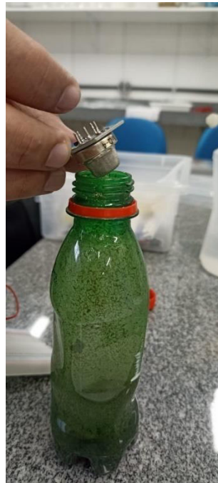
Figura 4 – Sensor MQ-4 medindo a concentração de metano contida na garrafa pet.
