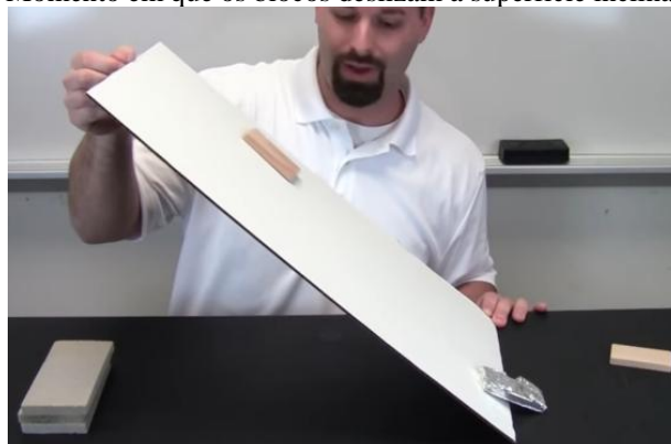
Figura 7. Momento em que os blocos deslizam a superfície inclinada.
