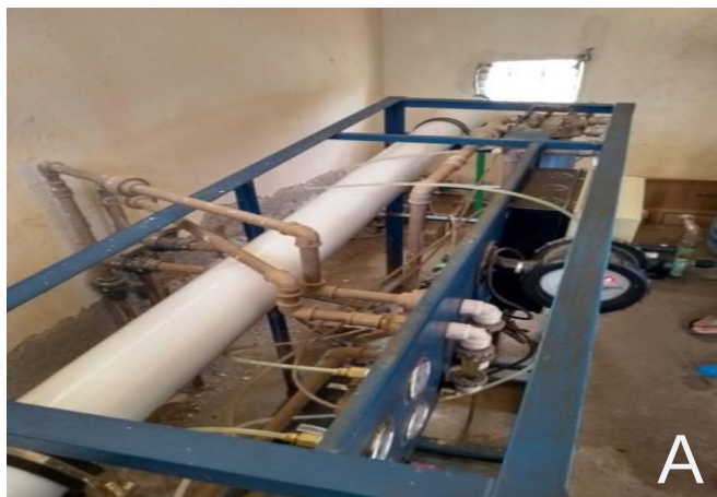
Figura 5: Dessalinizador por osmose reversa, fornecido pelo governo do Estado no povoado de Mutuca, em Pesqueira PE
