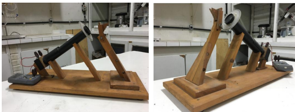
Figura 18. Polarímetro de baixo custo, construído como um artefato lúdico para fins educacionais.
