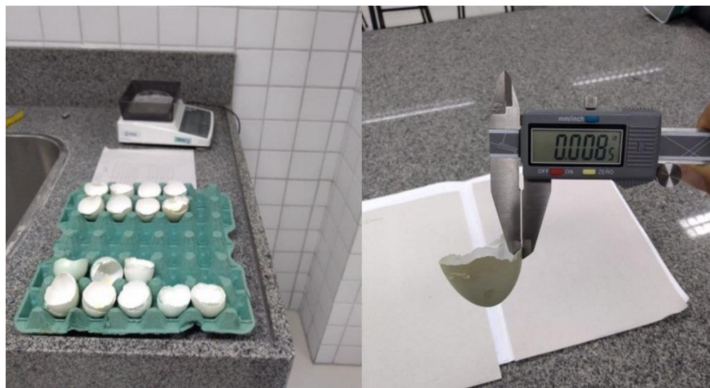
Figura 7- Pesagem da casca com auxílio de balança semi-analítica e dimensionamento de espessura da casca utilizando paquímetro digital (Fonte: Arquivo pessoal)
