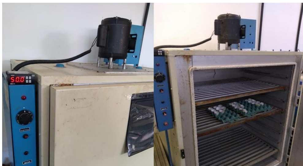
Figura 6- A esquerda, estufa à 50°C, à direita, deposição de casca de ovo na estufa (Fonte: Arquivo pessoal)
