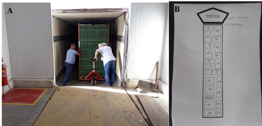
Figura 34: A – Container sendo carregado; B – Esquema da forma correta de carregar o container.
