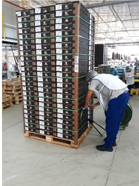
Figura 32: Fixação das cantoneiras e amarração dos paletes.
