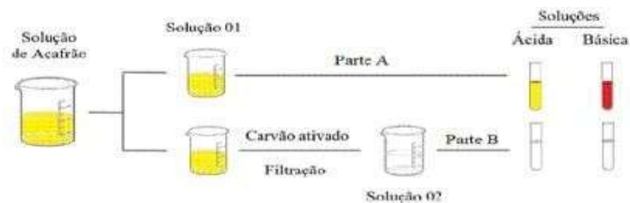
Figura 12. Esquema da preparação de soluções para o teste de indicação de acidez e basicidade
