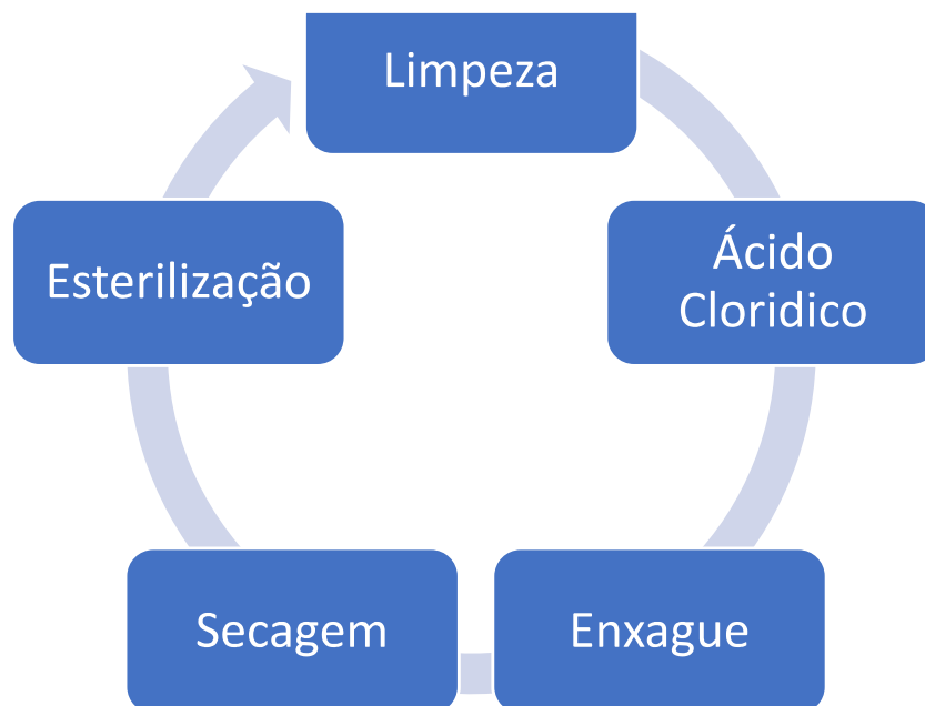
Figura 2. Fluxograma do procedimento de esterilização de materiais de reuso do Laboratório
