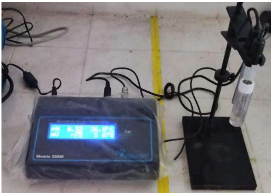
Figura 10: pHmetro de bancada
