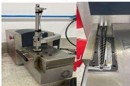
Figura 4 – Mini-extrusora de rosca dupla cônica HAAKE Minilab
