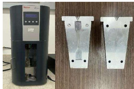
Figura 5 – Mini-injetora HAAKE MiniJet II e Molde
