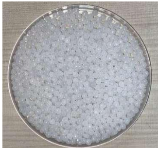
Figura 3 – Pellets de PEAD Virgem
