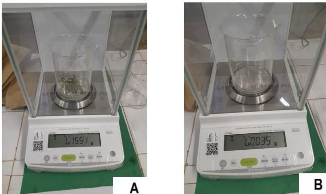
Figura 6. Pesagem da massa seca da parte aérea (A) e do sistema radicular (B) de plântulas de Astronium urundeuva Allemão.
