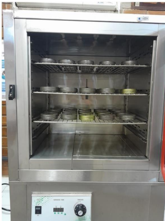
Figura 2. Avaliação do teor de água de diásporos de Astronium urundeuva Allemão.
