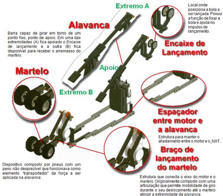
Figura 5 - Modelo inicial proposto da catapulta a ser montado e descrição de suas partes.
