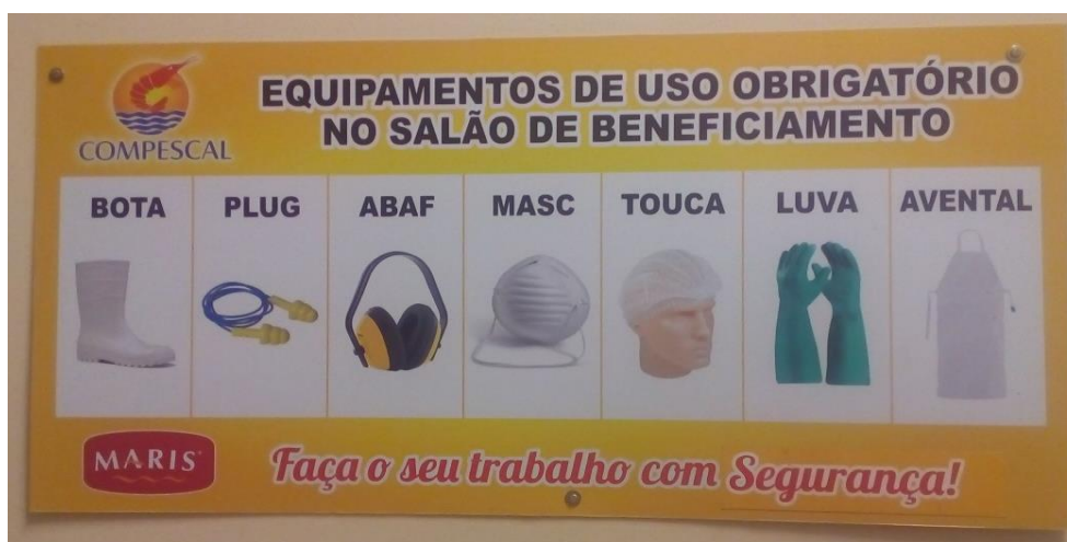
Figura 7- Equipamentos de proteção individual utilizados obrigatoriamente por todos os funcionários.
