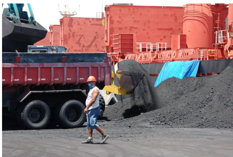
Figura 3. Sistema de desestiva do coque de petróleo de navio em sistema aberto, com dispersão do pó no entorno no Porto de Suape.
