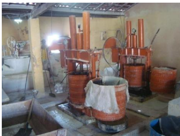
Figura 3 A - Prensa hidráulica em casa de farinha nº. 11 - Olho D' Água dos Pombos- Lajedo
