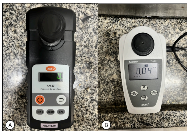
Figura 9 - Colorímetro (a) e turbidímetro (b) utilizados para analisar a cor e a turbidez da água e do gelo.
