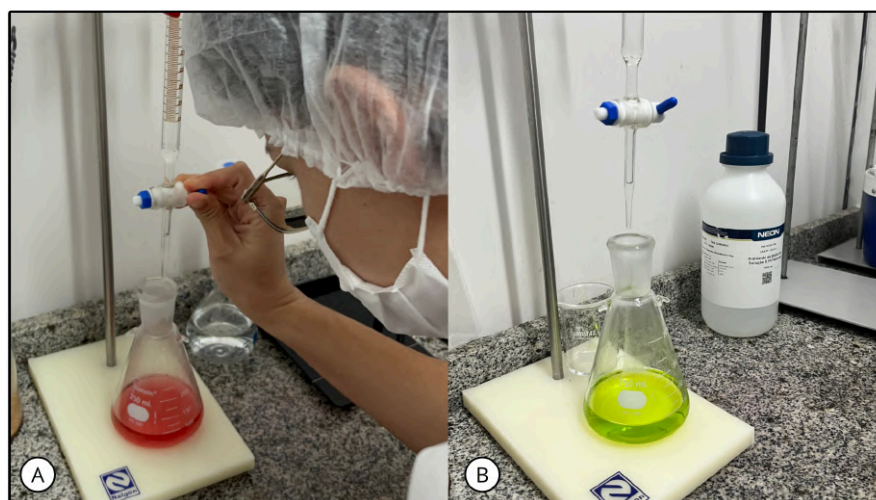
Figura 5 - Titulação para determinação de dióxido de enxofre ( \text{SO}_2 ) em camarão (a) e resultado da solução após a titulação (b).
