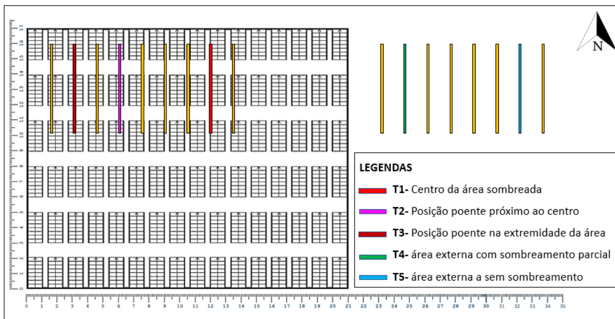
Figura 9 - Croqui em escala 1:1 ilustrando o sistema agrofotovoltaico e a área a céu aberto. Aldeia do Serrote - Itacuruba / PE, 2023.
