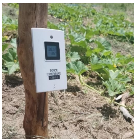
Figura 7 - Termohigrômetro instalado no centro das linhas de melão sem sombreamento (b). Aldeia do Serrote - Itacuruba / PE, 2023
