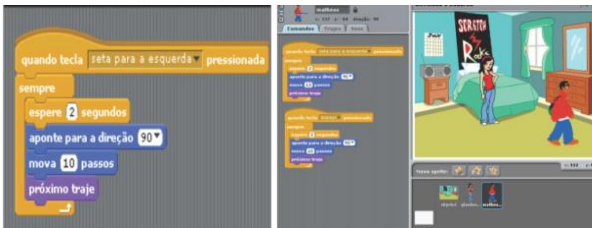
Figura 2.2 – Laços de repetição no Scratch
