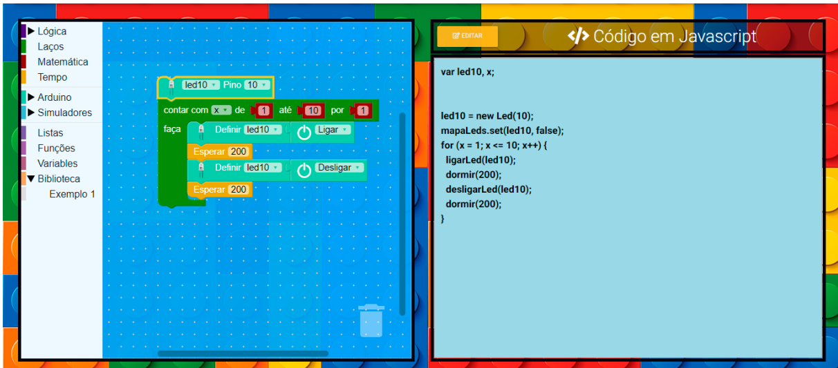
Figura C.1 – Programação em blocos e JavaScript para acionamento de um LED conectado ao Arduino
