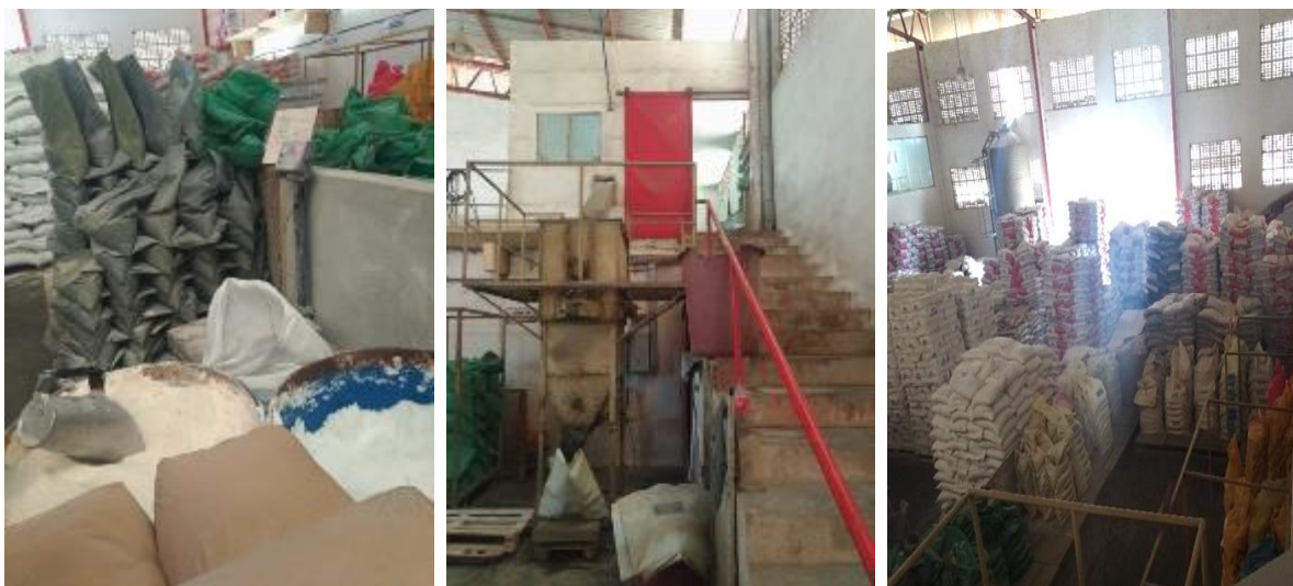
Figura 27 - Pesagem de micro (à esquerda), misturador de micro ingrediente (ao centro) e pré-misturas prontas para serem utilizadas (à direita)
