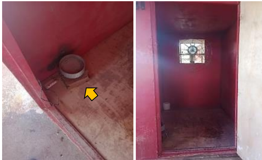
Figura 5 - Recipiente com paraformol e posterior fumigação em compartimento fechado
