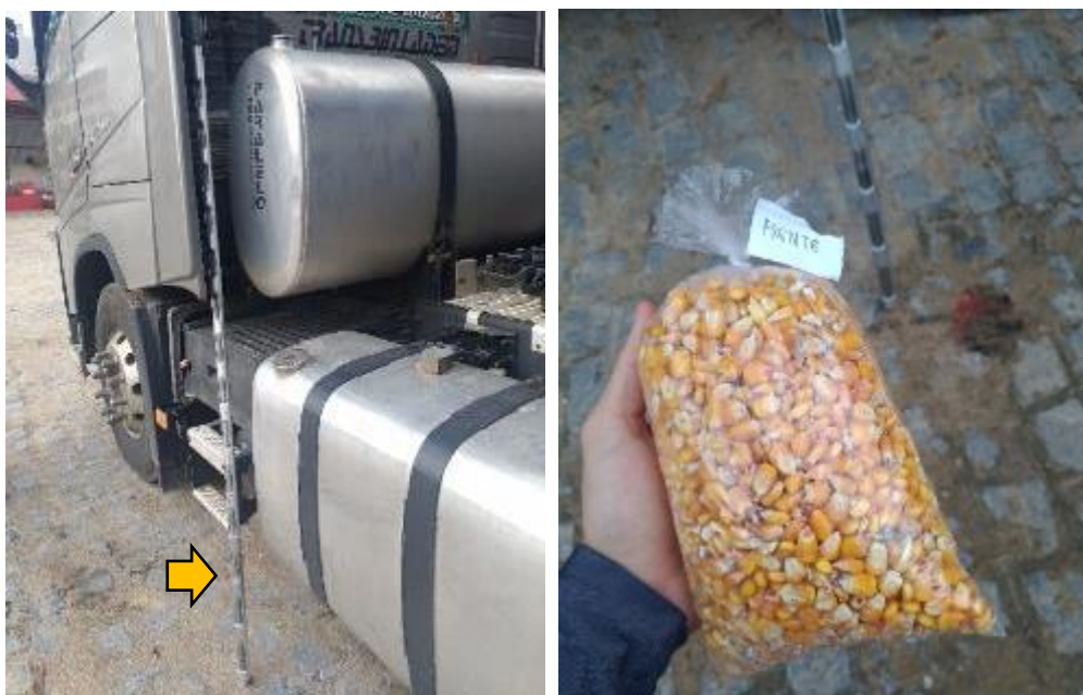
Figura 22 - Bastão de coleta de grãos (à esquerda) e amostra coletada para análise (à direita)
