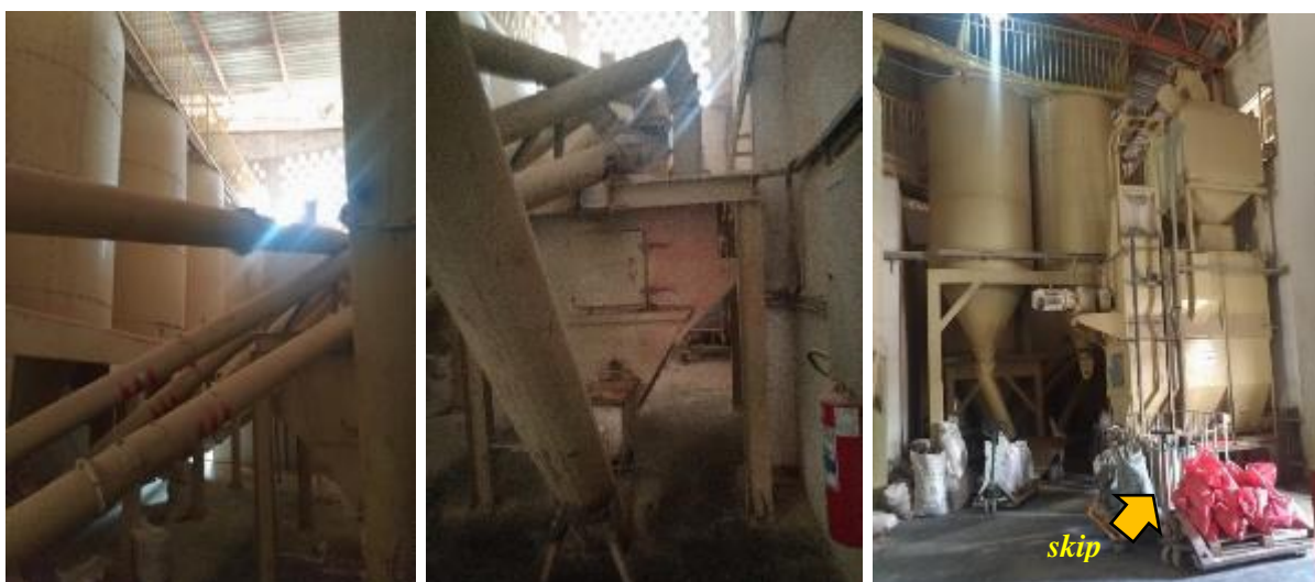
Figura 29 - Silos de dosagem, balança (centro) e à direita o pulmão e misturador com skip acoplado
