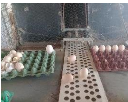
Figura 4 - Esteira automática trazendo ovos para serem coletados e separados
