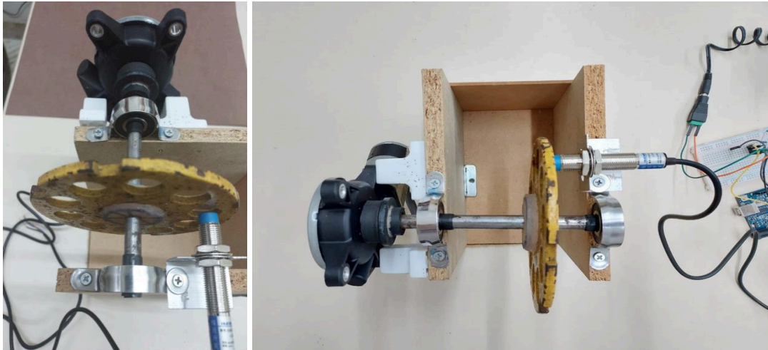
Figura 36: Protótipo para realização dos testes de bancada com o sensor indutivo
