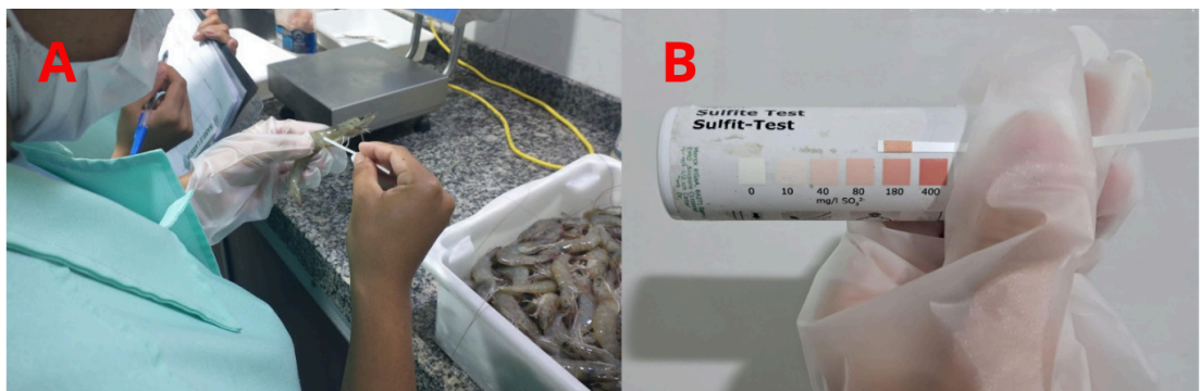
Figura 5. Análise de metabissulfito de sódio pela fita de Merk.
