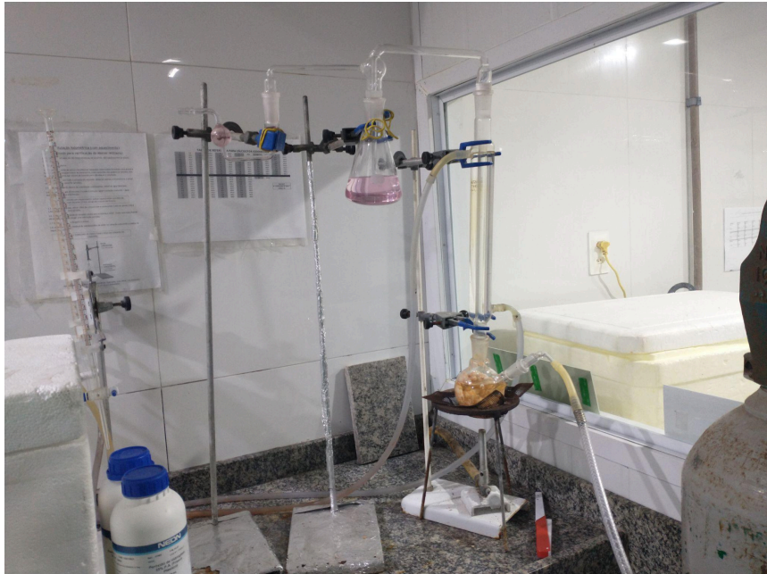
Figura 6. Método de destilação do Monier-Williams
