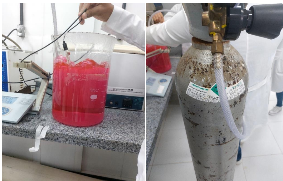
Figura 5. Saturação do meio nutritivo com dióxido de carbono (CO 2 ) para garantia da anaerobiose e ajuste do pH, antecedendo a adição do inóculo ruminal, Garanhuns-PE.
