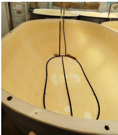
Figura 21 - Disposição das mangueiras micro perfuradas para aeração (fase I)
