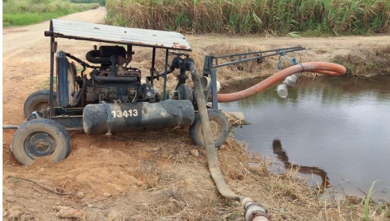
Figura 28- Motobomba móvel sendo preparado para captar a água.
