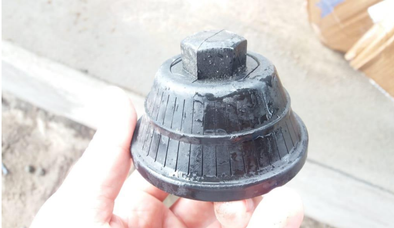
Figura 9 - A crepina impede a passagem da areia e permite a passagem da água filtrada.
