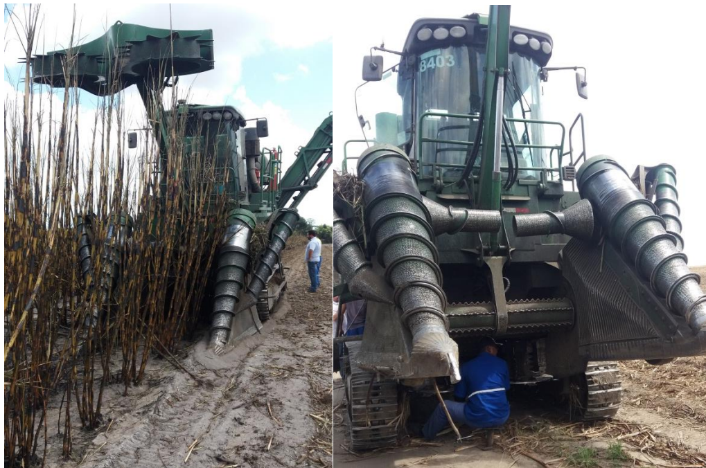
Figura 33 - Colhedora na linha de cana e manutenção com troca de faquinhas (corte de base).
