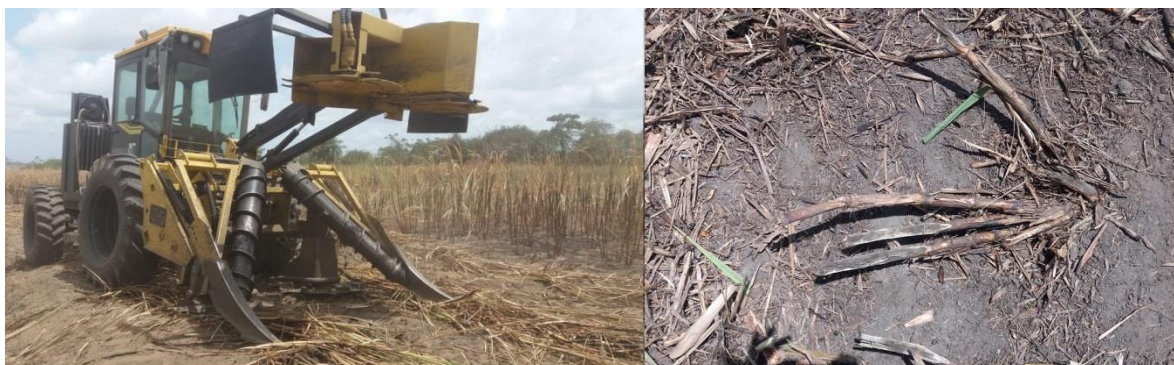
Figura 31- Cortadeira adaptada e uma de suas consequências, o estilhaçamento da cana
