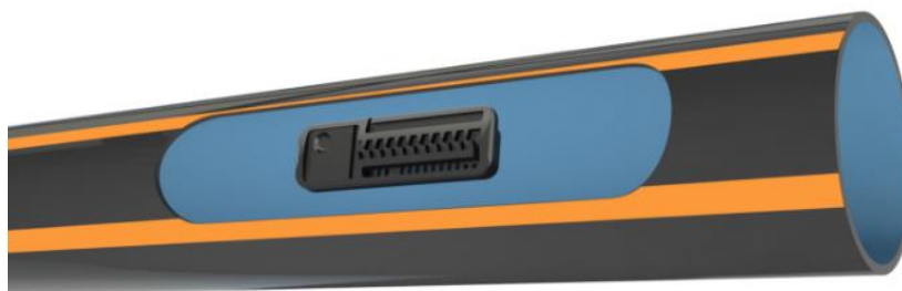
Figura 10 - Ilustração do formato de um gotejador, evidenciando a serpentina interna.
