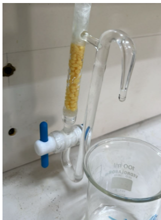
Figura 18- Passagem da solução de Zinco nos biossorventes
